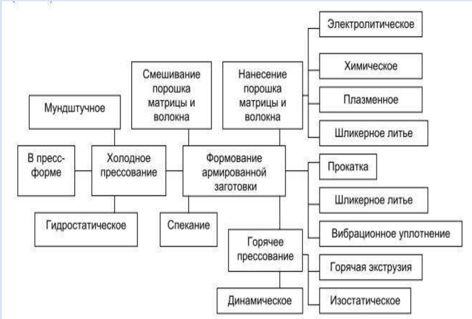
Схема технологического процесса получения МВКМ методами порошковой
